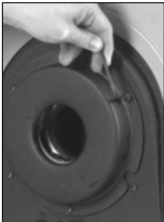
Figure 18A – Retrait de carter arrière du mandrin
