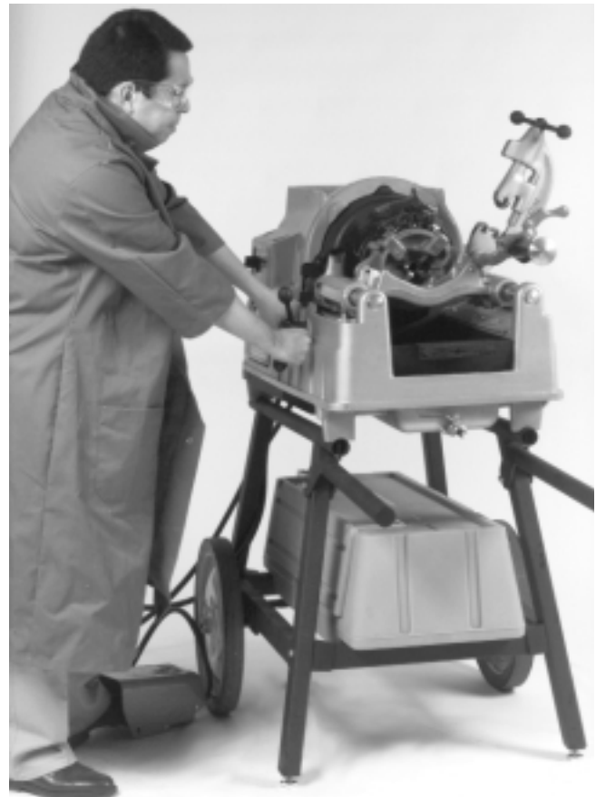
Figura 8 – Roscado con la Roscadora Automática No. 535
