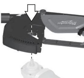
5. **AVERTISSEMENT !** Adaptez toujours le capot de protection afin d'assurer une protection maximale à l'opérateur pendant son utilisation. Choisissez l'angle de coupe approprié pour l'utilisation visée.
